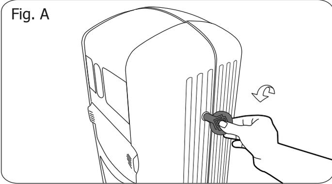
1. Inserte la llave en la cerradura (Fig. A) y coloque la mano izquierda en el hueco del dispensador de bolsas. Gire la llave en sentido contrario a las agujas de reloj.
